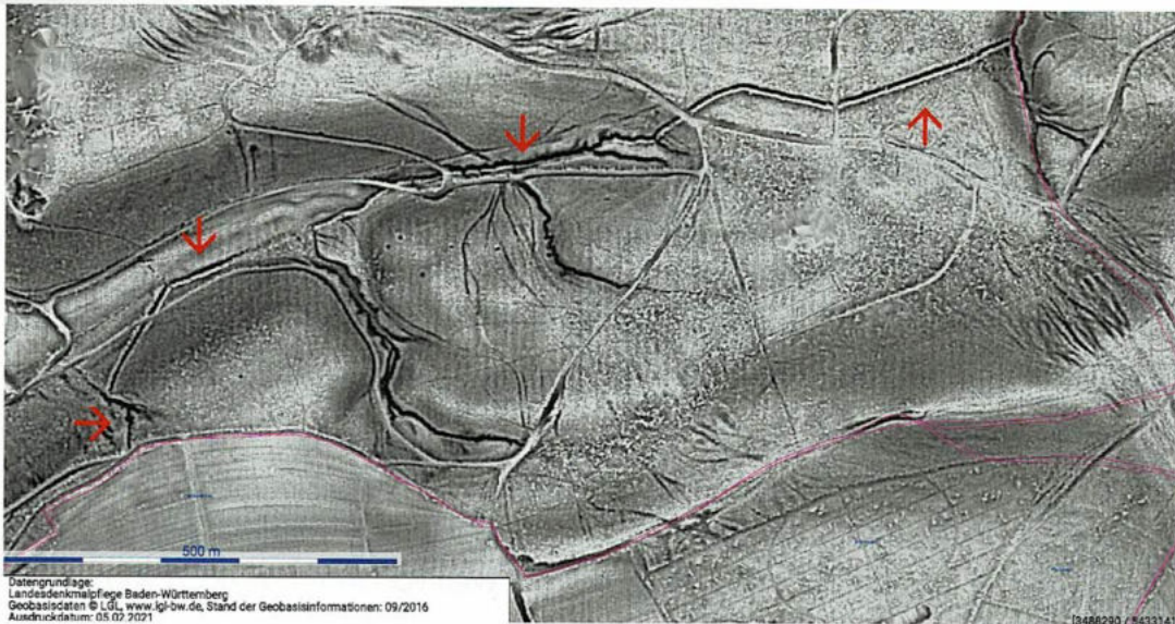
11 Der auf der Oberderdinger Gemarkung West-Ost-verlaufende Landgraben endet im Osten an einer Klinge. Gut erkennbar sind die Vorsprünge sowie mittig die integrierte Klinge.
